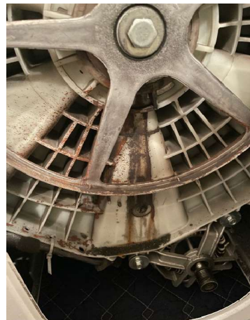
※写真：損傷しているドラム(背面)
